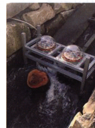
↑ 小水力発電の実験の様子 (防犯灯に換算すると11基分の発電量があります)
